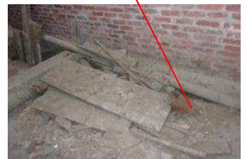
Conduit en amiante-ciment
